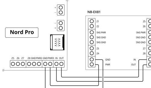
Внешние подключённые коммутируемые устройства должны запитываться только от клеммы PWR изделия. Использование внешнего источника для питания коммутируемых устройств недопустимо.
