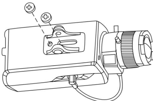
9. Закрепите кронштейн на поверхности с помощью винтов.
