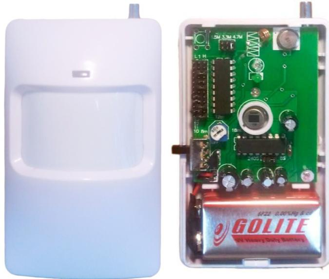
2. Отключить питание датчика (вытащить батарейку, если датчик без выключателя).
