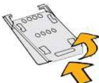
Снимите заднюю крышку, закрывающую отсек для SIM-карты.
