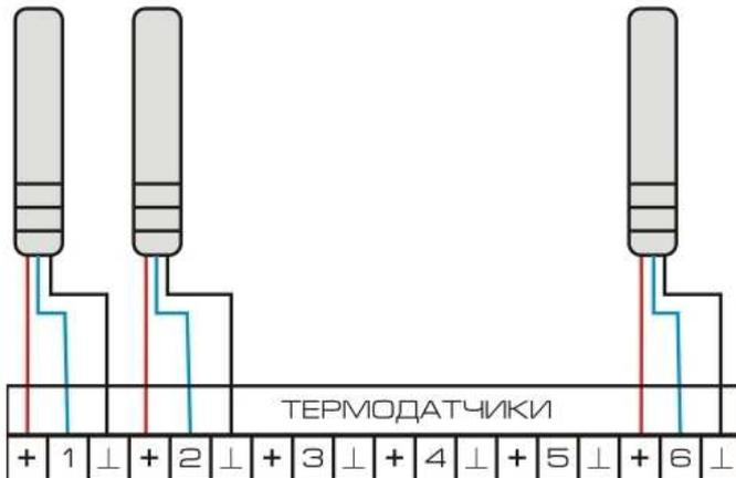
Системой Sapsan GSM Pro 6 поддерживается подключение до 6 температурных датчиков
