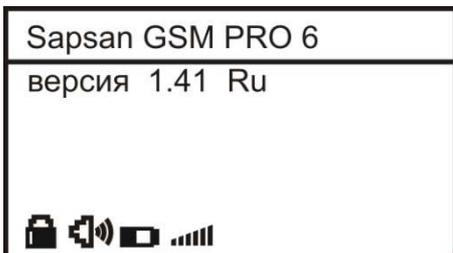
Стартовый экран на LCD дисплее отображает название, версию прошивки контрольной панели, а также условные изображения режимов работы.
