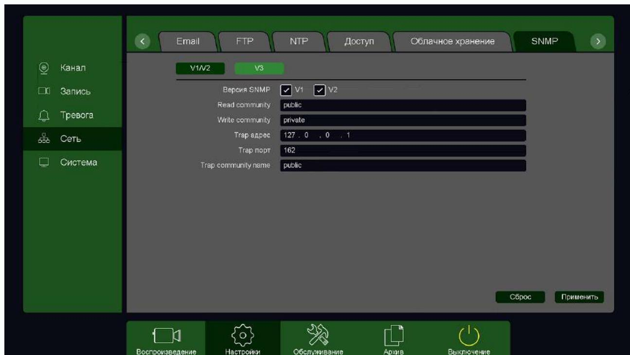
**SNMP** (Simple Network Management Protocol) — протокол, который используется для управления сетевыми устройствами. С помощью протокола SNMP, программное обеспечение для управления сетевыми устройствами может получать доступ к информации, которая хранится на управляемых устройствах (например, IP камере или видеорегистраторе).
