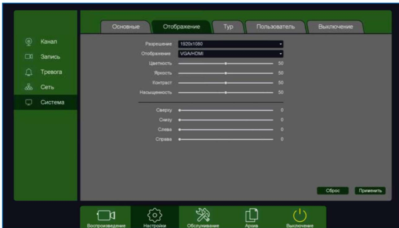
**Разрешение** – разрешение изображение на подключенном мониторе.
