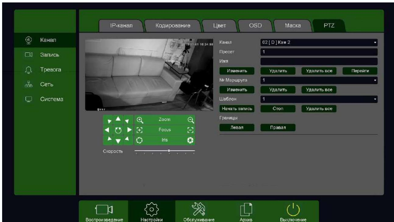
В данном меню производится настройка пресетов, маршрутов и шаблонов подключаемой PTZ камеры.
