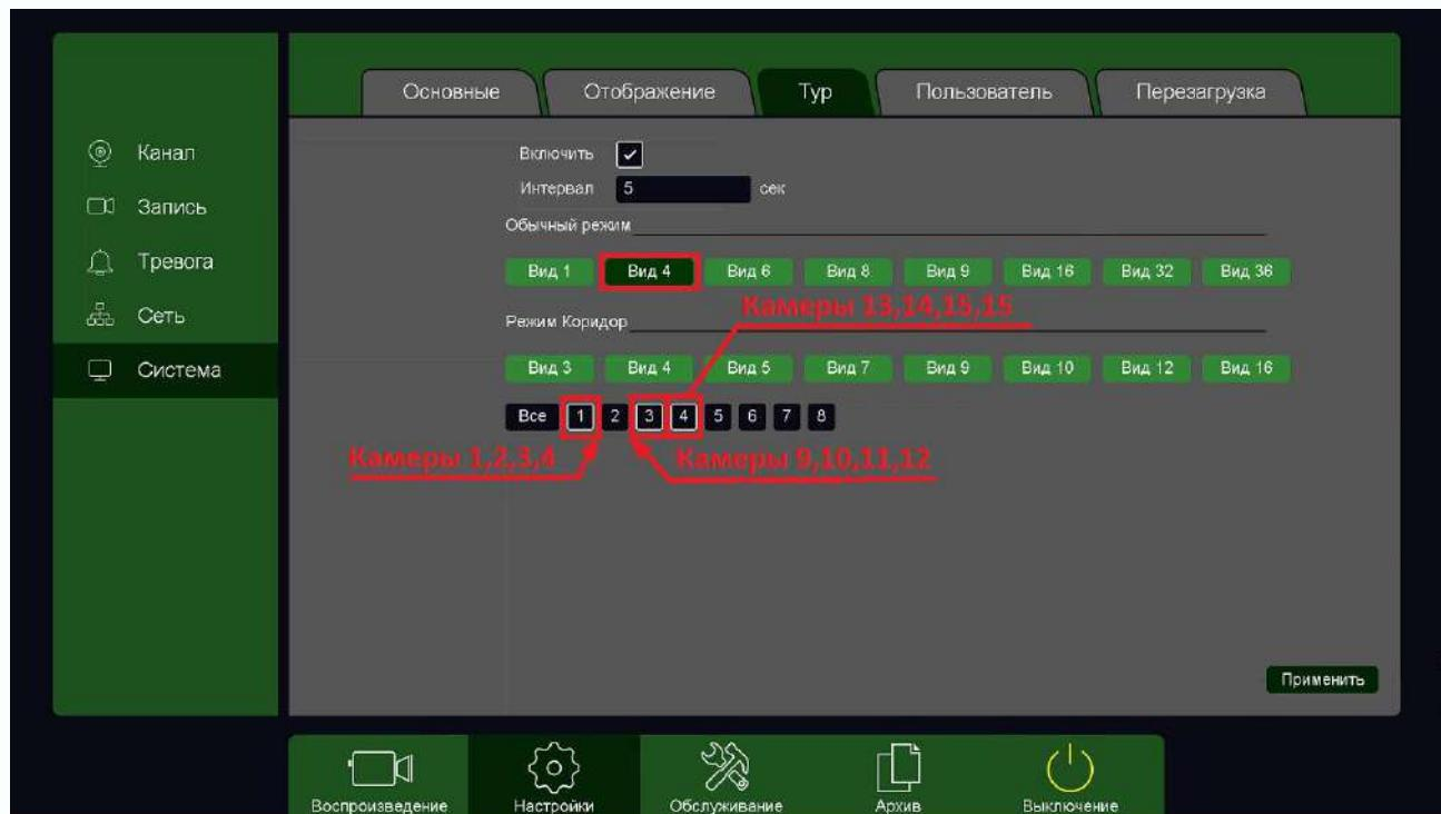
Для того, чтобы при включении тура отобразить нужную последовательность отображения камер, снимите галочки с ненужных видов и групп камер, оставьте активными только нужные виды и группы камер, нажмите **Применить**.
