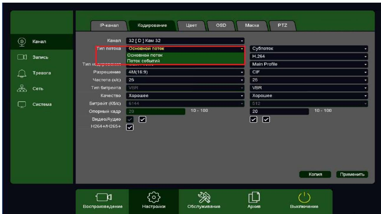
Регистратор позволяет настроить запись видео следующим образом: при непрерывной записи запись осуществляется с одним количеством кадров в секунду (например, 1-5 кадров в секунду), а при возникновении любого тревожного события (срабатывания детектора движения, детектора видеоаналитики и т.д.) запись осуществляется с другим количеством кадров в секунду (например, 25 кадров в секунду).
