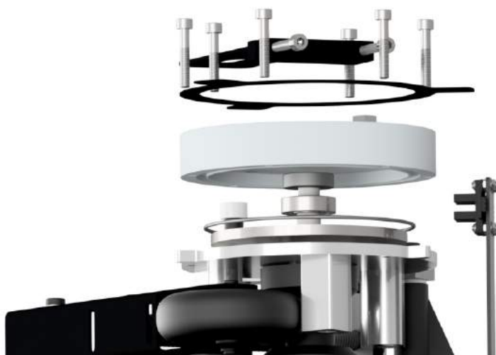
Рисунок 28 – Порядок замены сальника
