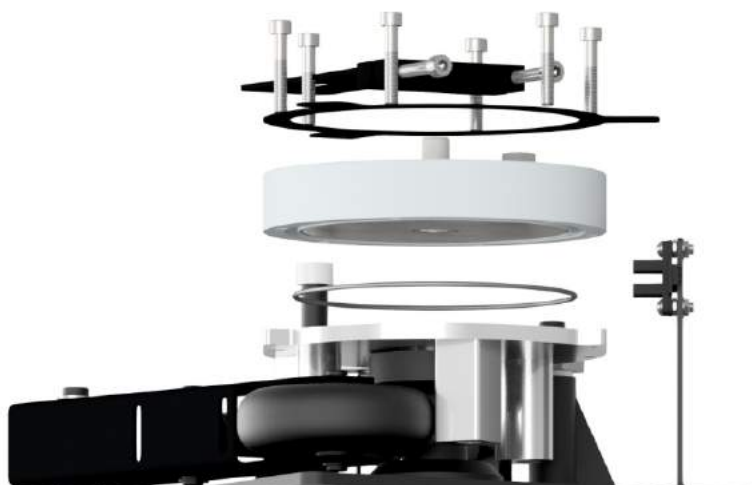
Рисунок 27 – Порядок замены уплотнительного кольца
