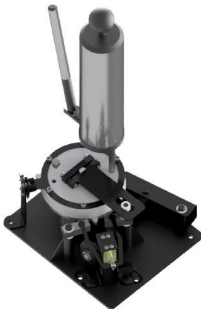
Рисунок 29 – Доливка демпферной жидкости
