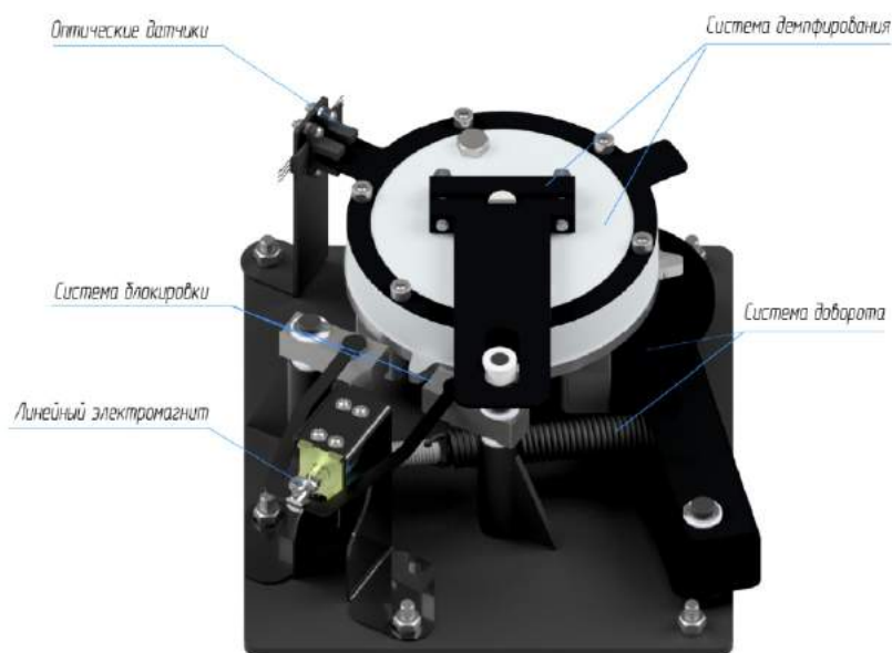
Рисунок 4 – Устройство механизма турникета
