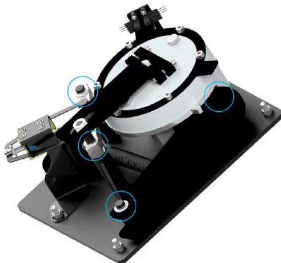
Рисунок 31 – Места смазки подвижных частей
