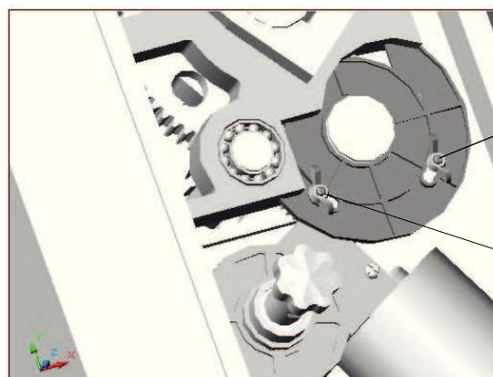
Винт магнитного выключателя открытия NO-контакты
