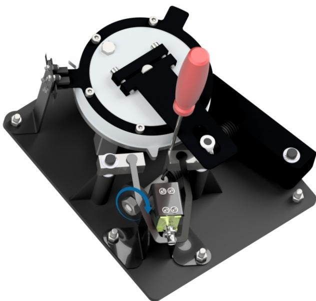
Рисунок 31 – Регулировка натяжения пружины доводчика
