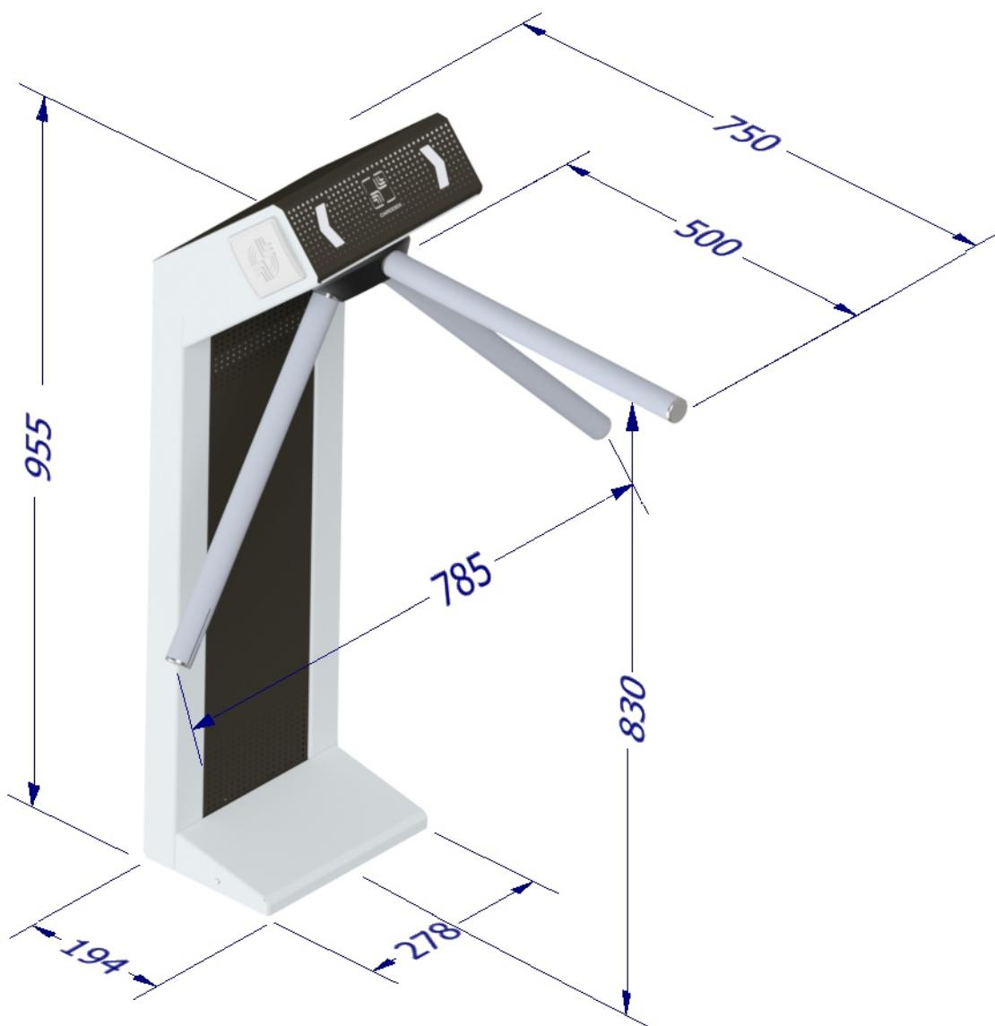
Рисунок 1 – Габаритные размеры ЭП с планками
