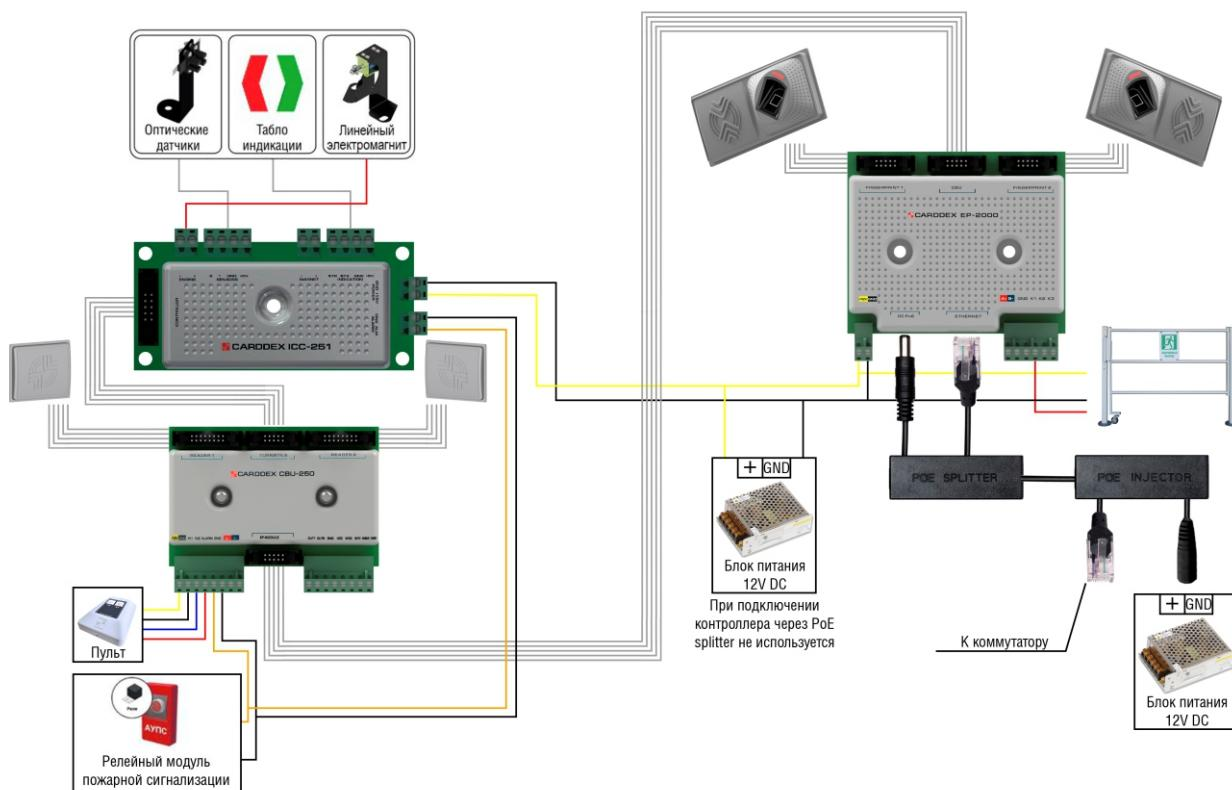
Рисунок 20 – Схема основных подключений электронной проходной
