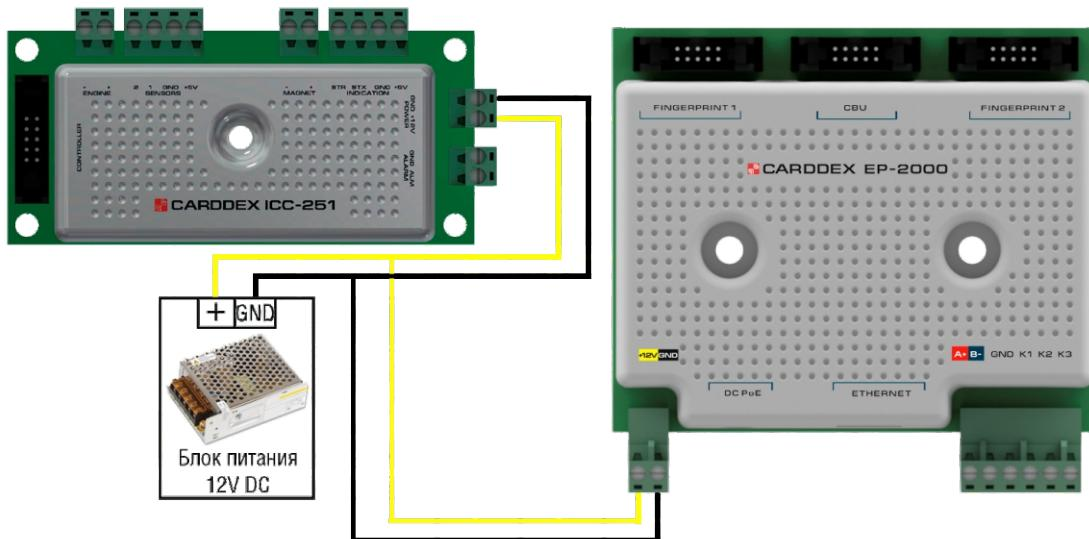
Рисунок 24 – Подключение питания к электронной проходной
