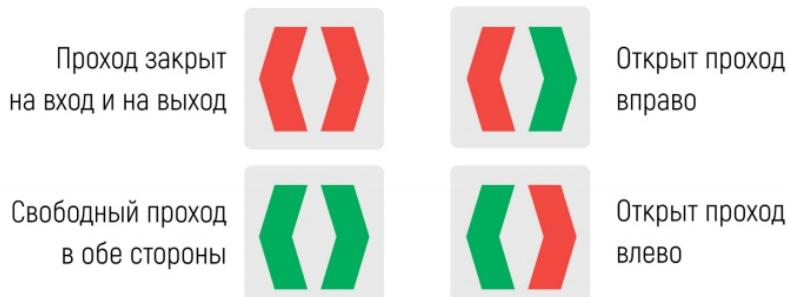
Рисунок 11 – Режимы индикации электронной проходной
