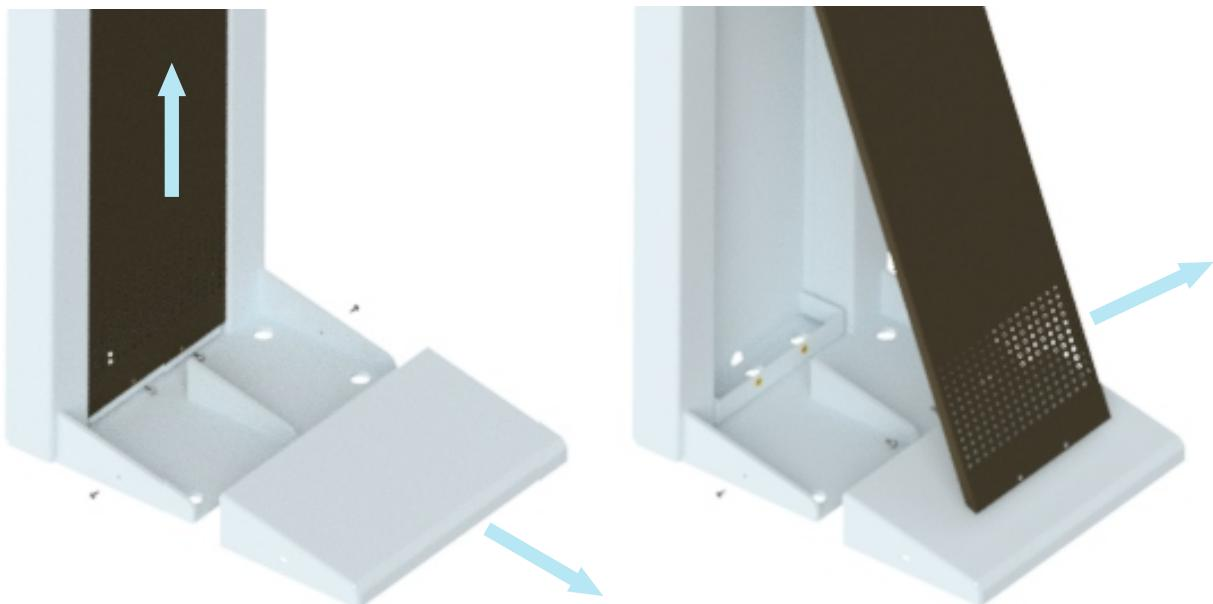
Рисунок 26 – Демонтаж центрального кожуха ЭП
