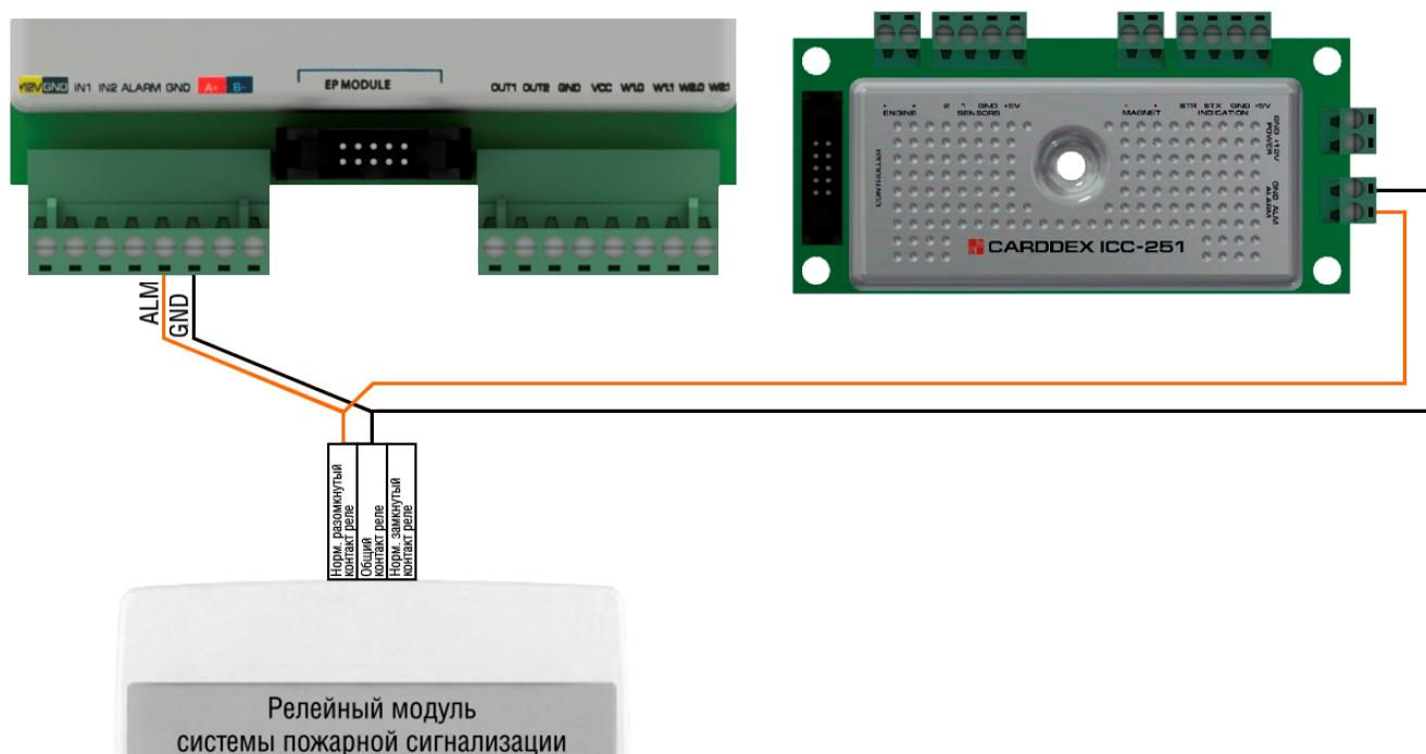
Рисунок 23 – Подключение АУПС к электронной проходной
