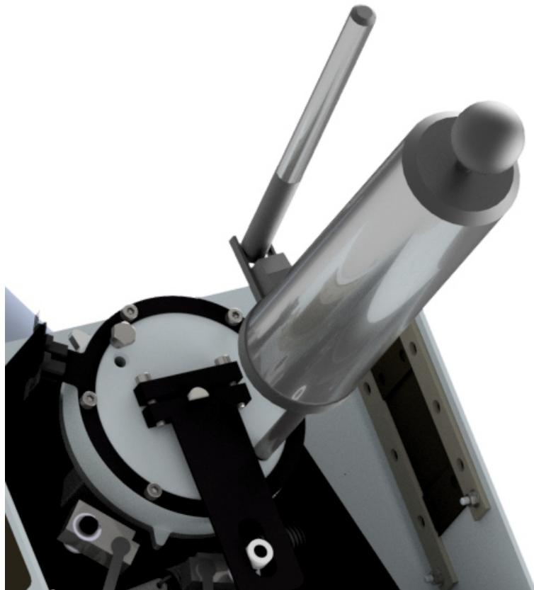
Рисунок 30 – Доливка демпферной жидкости
