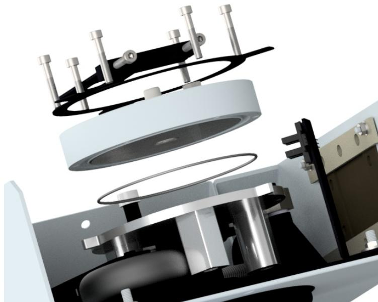
Рисунок 28 – Порядок замены уплотнительного кольца
