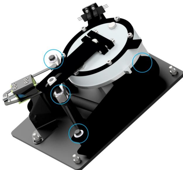
Рисунок 32 – Места смазки подвижных частей механизма
