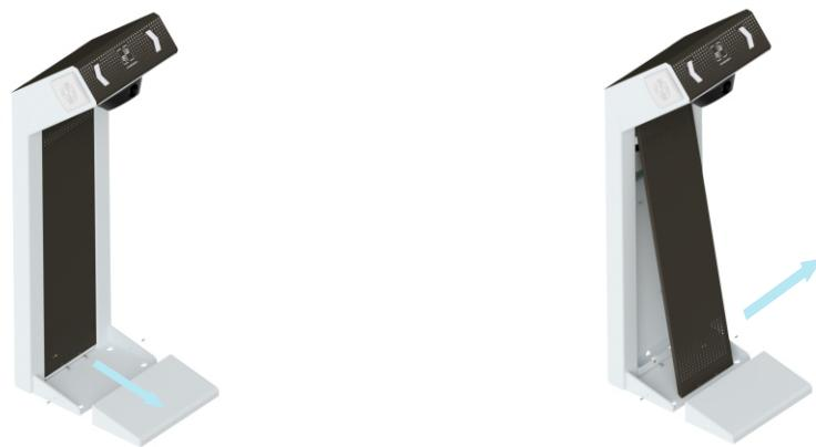
Рисунок 16 – Разборка кожухов ЭП
