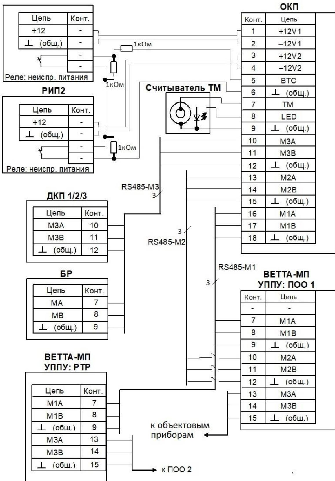
Рис. 5. Схема соединений ОКП (СПИ с «ВЕТТА-МП»)
