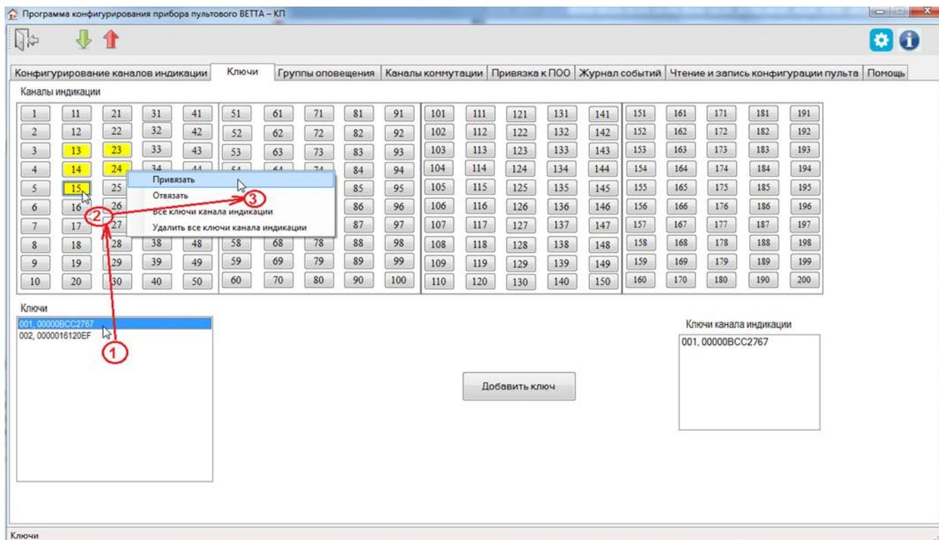
Рис. 25. Привязка ключей ТМ к каналам индикации
