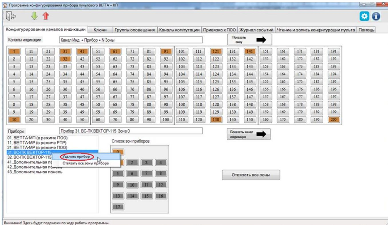
Рис. 30. Отвязка устройства от ОКП
