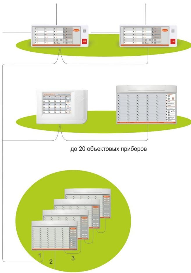
В простейшем случае организации взаимодействия объектовых приборов с пультовым прибором, каждый объектовый прибор подключается непосредственно к одной из двух проводных системных магистралей RS–485 (№1, №2), управляемых контрольной панелью «ВЕТТА–ОКП». Объектовые приборы могут размещаться на расстоянии до 1000 метров от пультового прибора, не требуя использования дополнительного связного оборудования.
