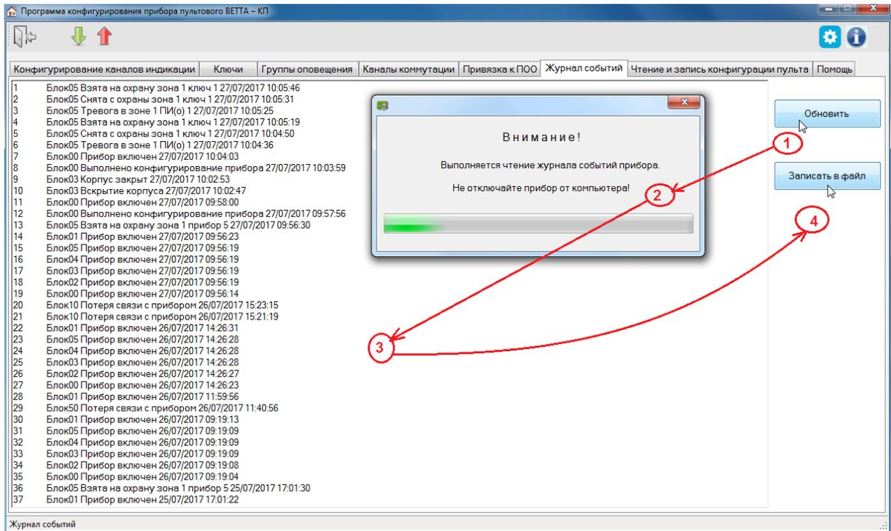
Рис. 31. Порядок действий при чтении журнала событий системы
