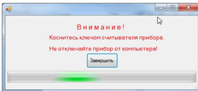
10) Коснитесь считывателя ключом (сопровождается коротким звуковым сигналом ОКП), и дождитесь появления новой записи с кодом ключа в окне «Ключи» (рис. 21, шаг 4). Последовательно повторяйте операцию для добавления других ключей.
