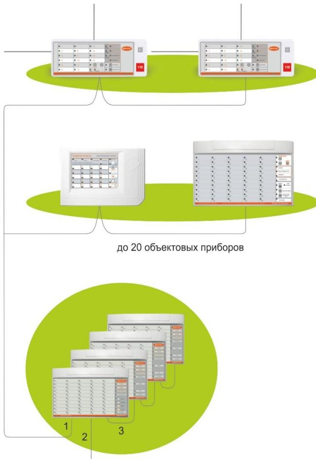
В простейшем случае организации взаимодействия объектовых приборов с пультовым прибором, каждый объектовый прибор подключается непосредственно к одной из двух проводных системных магистралей RS-485 (№1, №2), управляемых контрольной панелью «BETTA-ОКП». Объектовые приборы могут размещаться на расстоянии до 1000 метров от пультового прибора, не требуя использования дополнительного связного оборудования.
