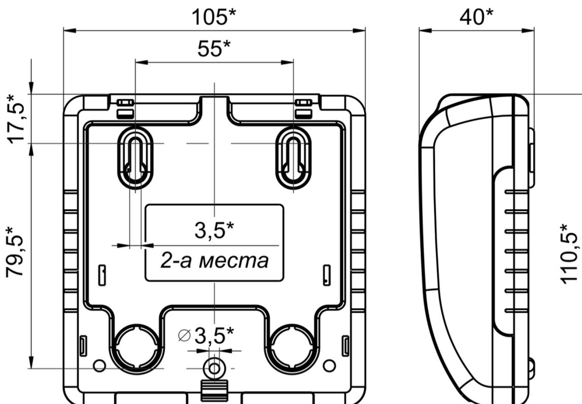
Рис. 2. Габаритные и установочные размеры блока реле «ВЕТТА-БР», УППУ «ВЕТТА-МП», блока коммуникационного «ВЕТТА-МК»
