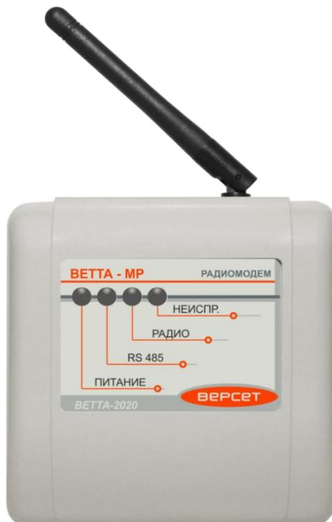
Универсальное приемопередающее устройство с модемом радиоканала «ВЕТТА–МР» (УППУ «ВЕТТА-МР», устройство) предназначено для обеспечения радиоканальной связи между элементами системы передачи извещений «ВЕТТА–2020». Организация радиоканала в СПИ обеспечивается, как минимум, двумя УППУ «ВЕТТА–МР», одно из которых, в режиме ВЕДУЩИЙ, подключается через проводную линию связи RS–485 к ОКП пультового прибора, а второе – в режиме ВЕДОМЫЙ, через такую же линию связи к объектовым приборам.
