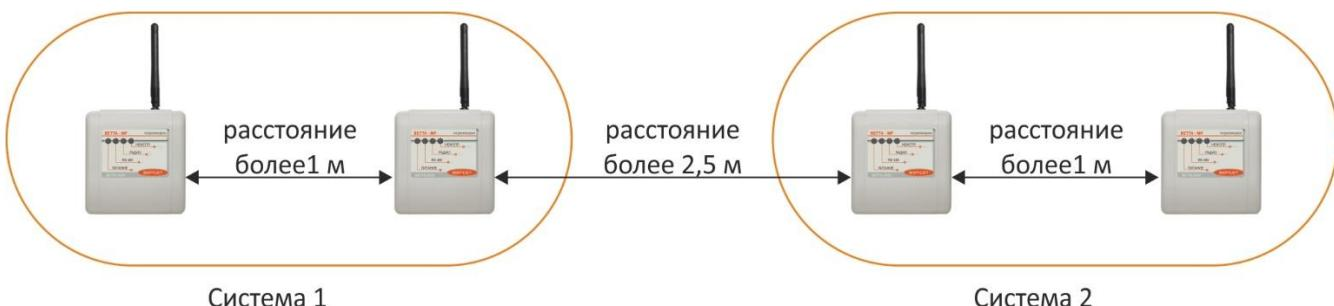
При размещении радиомодемов «BETTA-MP» двух систем «BETTA-2020» монтируйте радиомодемы разных систем на как можно большем расстоянии друг от друга. Минимальное рекомендованное расстояние в данном случае составляет 2.5 м.
