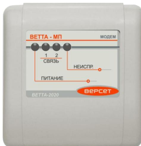
Универсальное приемопередающее устройство с модемом проводного канала «ВЕТТА–МП» (УППУ «ВЕТТА-МП», устройство) предназначено для обеспечения проводной связи между элементами системы передачи извещений «ВЕТТА–2020». В зависимости от применения в СПИ, «ВЕТТА–МП» выполняет функции прибора объектового оконечного (ПОО) или ретранслятора (РТР).
