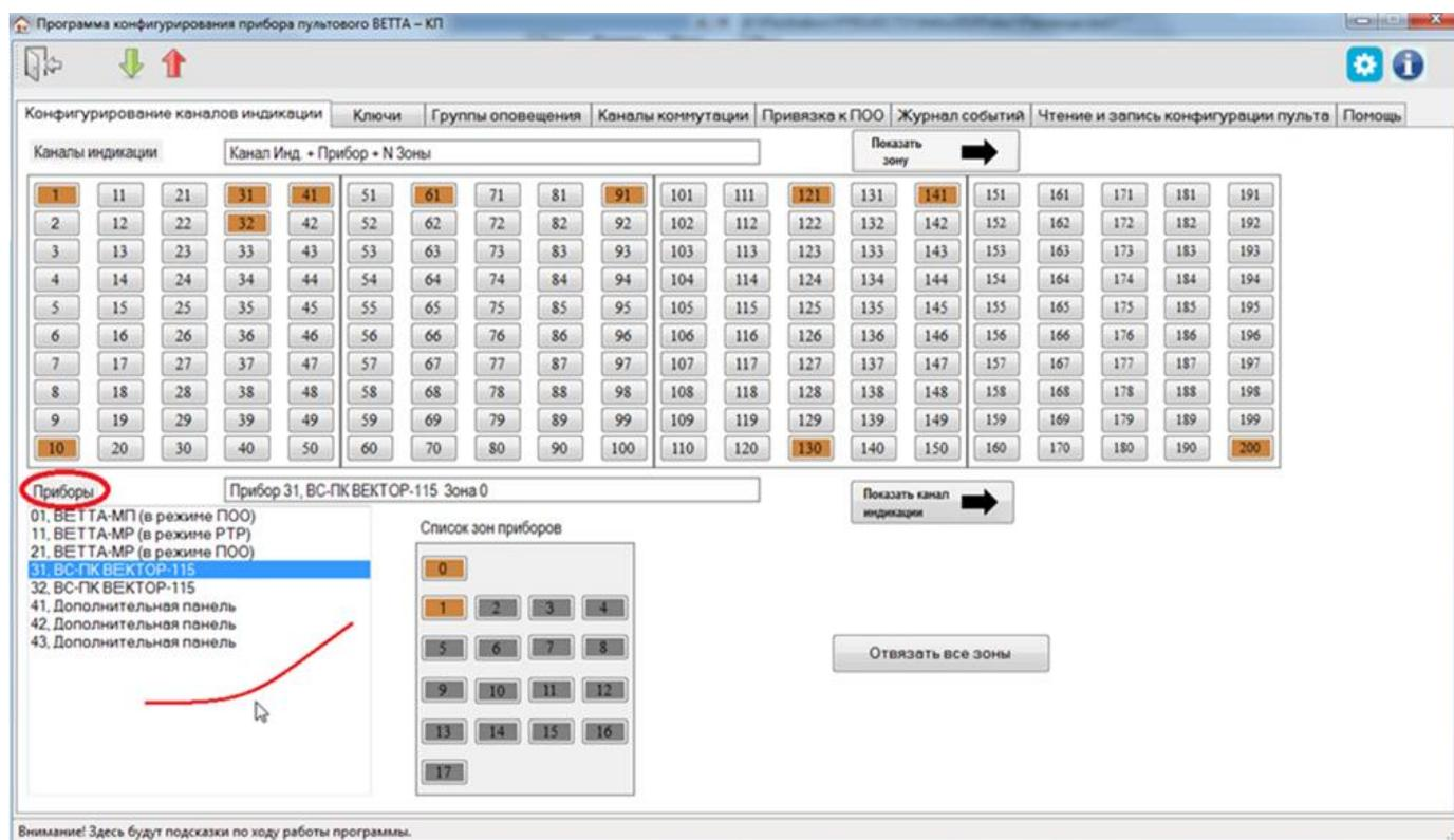
7) Список «Приборы» содержит актуальный список устройств, привязанных к ОКП, с указанием соответствующих системных адресов. Проверьте, что все привязанные Вами устройства присутствуют в этом списке.
