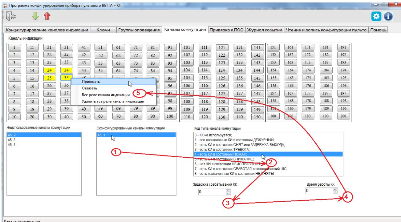
Рис. 28. Порядок действий при настройке канала коммутации блока реле «BETTA-BP»
