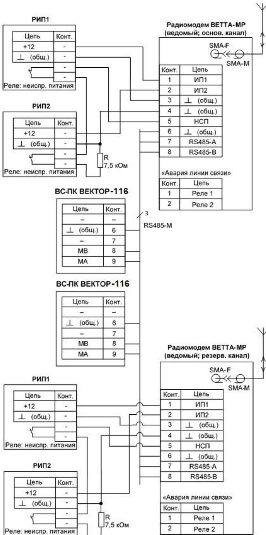
Рис. 12. Схема соединений УППУ «BETTA-MP» с резервированием радиоканалов
