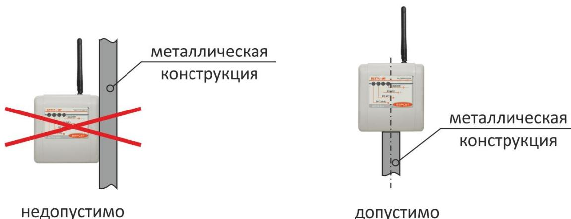
Учитывайте, что при установке радиомодема на крыше здания и наличии в месте его размещения габаритных металлических конструкций, ориентированных параллельно поверхности крыши, диаграмма направленности штыревой антенны искажается, что приводит к излучению большей доли энергии в верхнюю полусферу.
