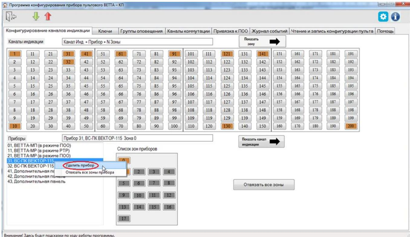
Рис. 30. Отвязка устройства от ОКП
