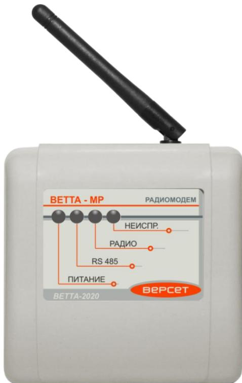
Универсальное приемопередающее устройство с модемом радиоканала «BETTA-MP» (УППУ «BETTA-MP», устройство) предназначено для обеспечения радиоканальной связи между элементами системы передачи извещений «BETTA-2020». Организация радиоканала в СПИ обеспечивается, как минимум, двумя УППУ «BETTA-MP», одно из которых, в режиме ВЕДУЩИЙ, подключается через проводную линию связи RS-485 к ОКП пультового прибора, а второе – в режиме ВЕДОМЫЙ, через такую же линию связи к объектовым приборам.
