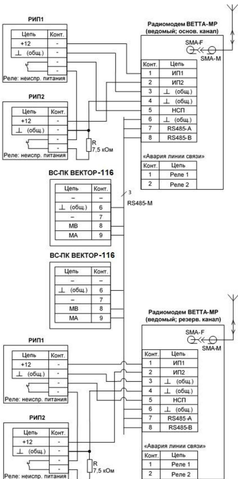
Рис. 12. Схема соединений УППУ «ВЕТТА-МР» с резервированием радиоканалов
