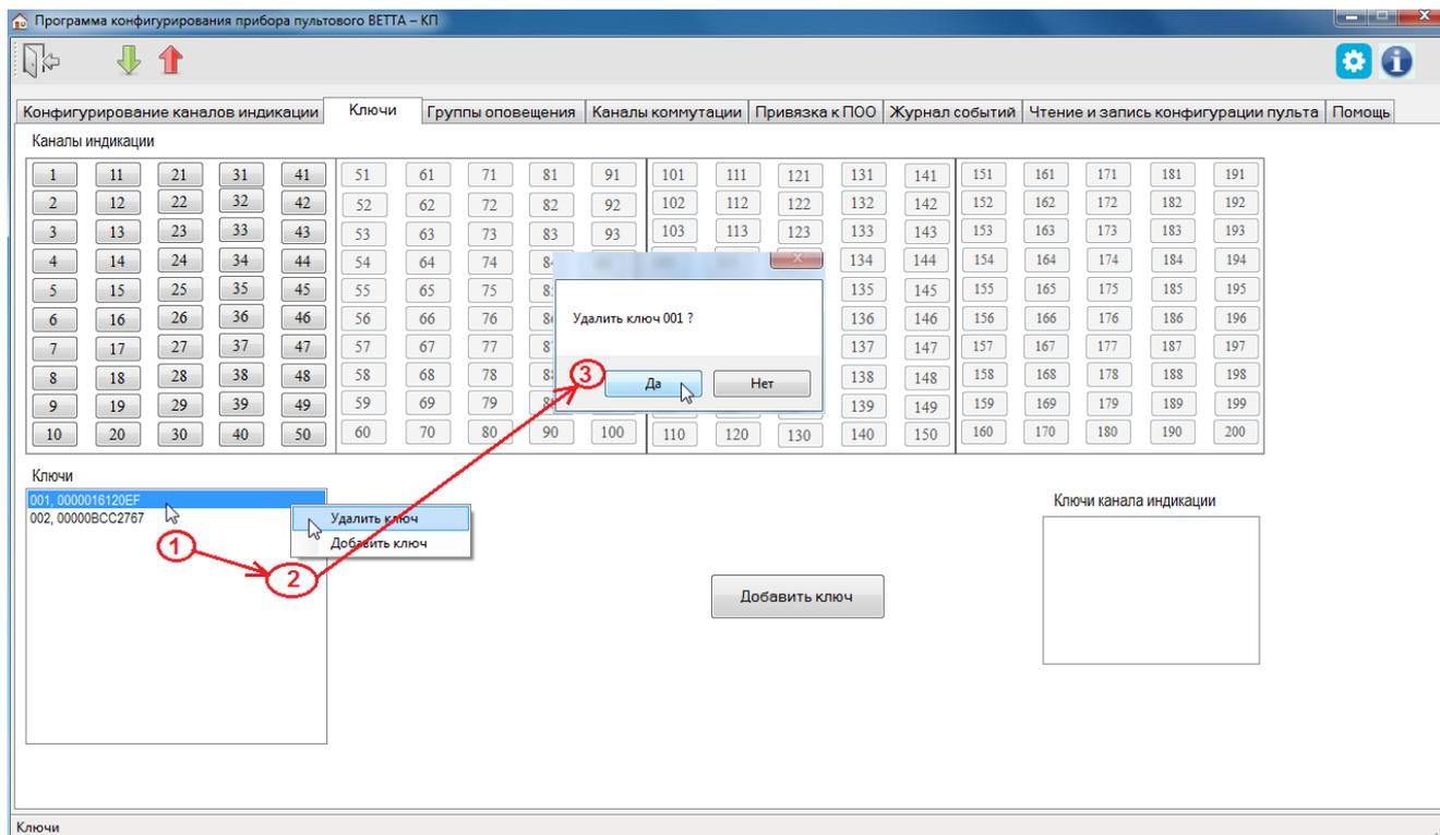
Рис. 24. Порядок действий при удалении ключа Touch Memory
