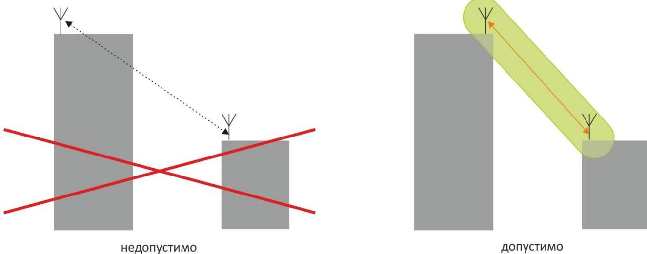
Если местность не позволяет разместить пару ведущий-ведомый радиомодемов в прямой видимости, то в данном случае, возможно, лучший вариант окажется при работе по отражённому сигналу (вариант 2 ниже). Однако в данном случае найти оптимальное расположение радиомодемов на концах радиотрассы значительно сложнее.
