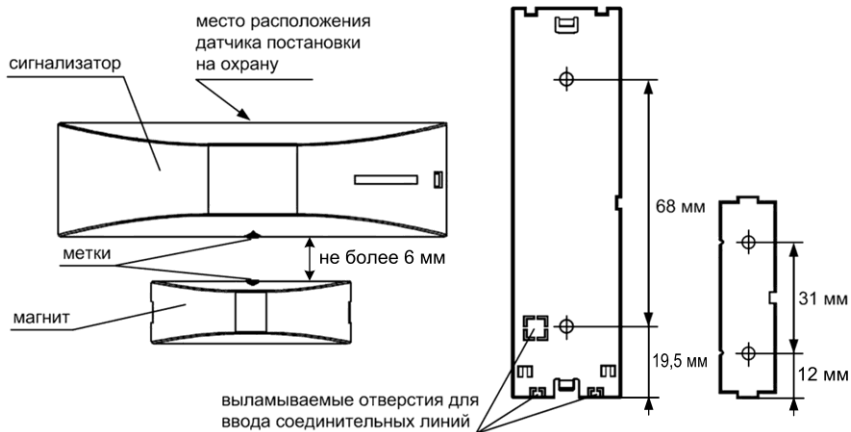
Рис.9 Схема установки, установочные и присоединительные размеры
