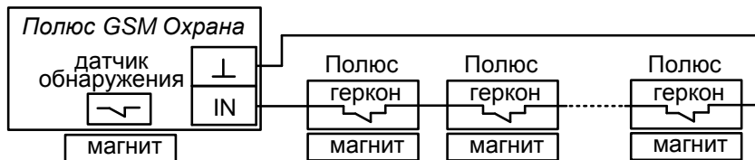
Рис.6а Схема подключения внешних датчиков. Значение «2» параметра №37
