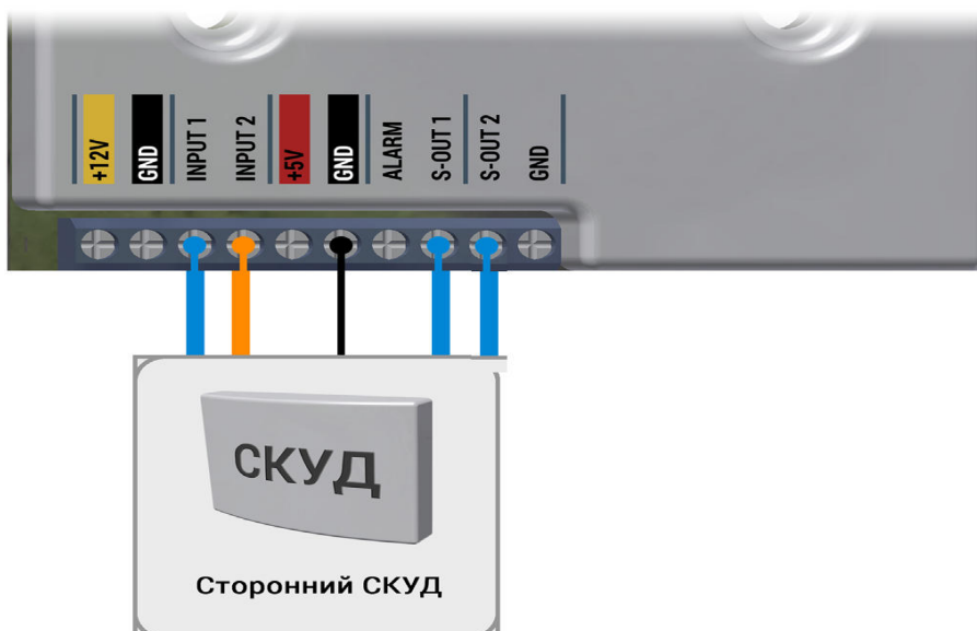
Рисунок 21 - Подключение турникета к СКУД
