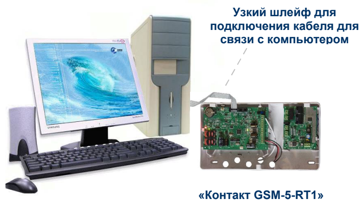
Рис.1.1. Пример подключения охранного прибора («Контакт GSM-5-RT1») к компьютеру.
