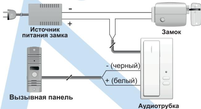
Схема подключения панелей со встроенной видеокамерой
