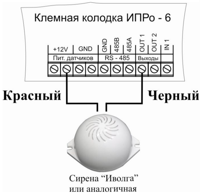
Подключение сирены с током потребления до 1А
