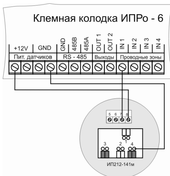
Подключение 1 датчика
