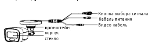
Рисунок 1-5 Цилиндрическая камера IV типа
