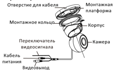
Рисунок 1-20 Камера «шар» V типа
