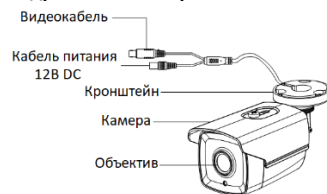
Рисунок 1-4 Цилиндрическая камера III типа
