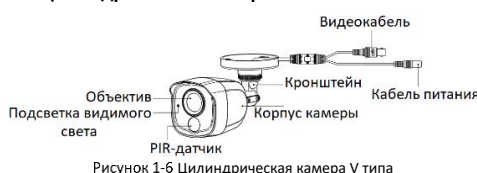
Рисунок 1-6 Цилиндрическая камера V типа
