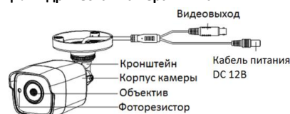
Рисунок 1-3 Цилиндрическая камера II типа
