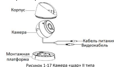
Рисунок 1-17 Камера «шар» II типа
