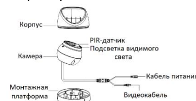
Рисунок 1-18 Камера «шар» III типа
