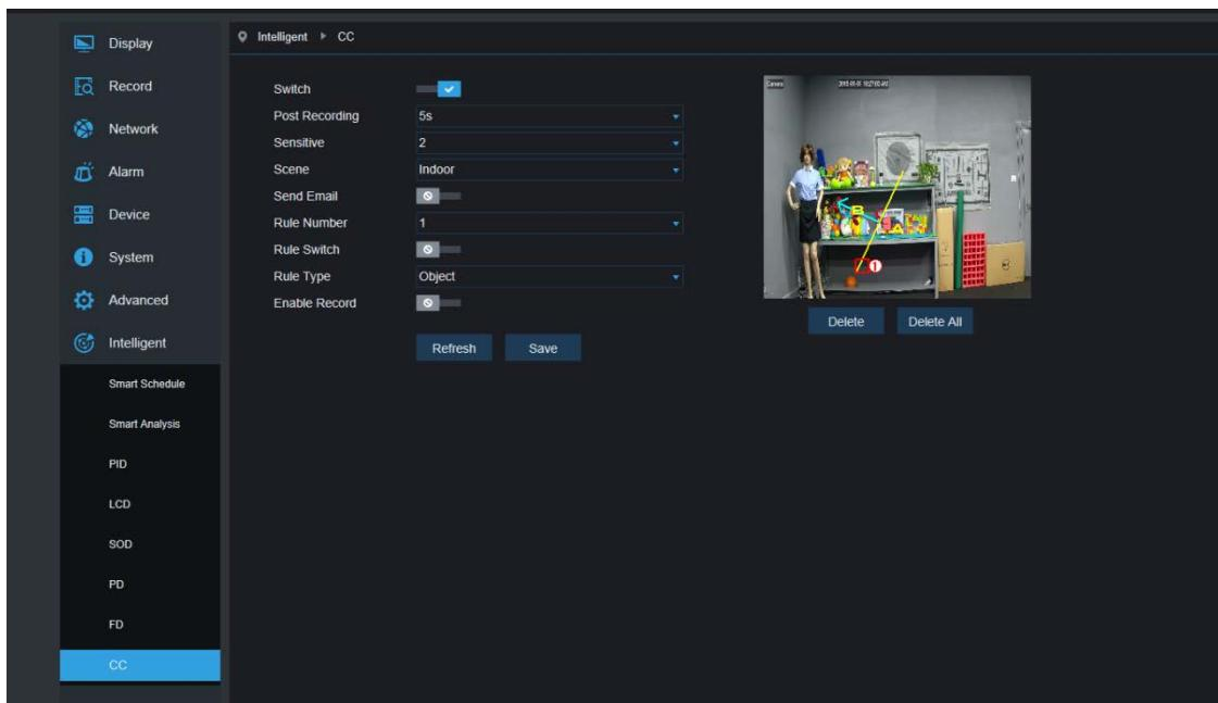
Описание функции: Фиксация и подсчет пересечений линии движущимися объектами и пешеходами, отображение на странице предварительного просмотра
