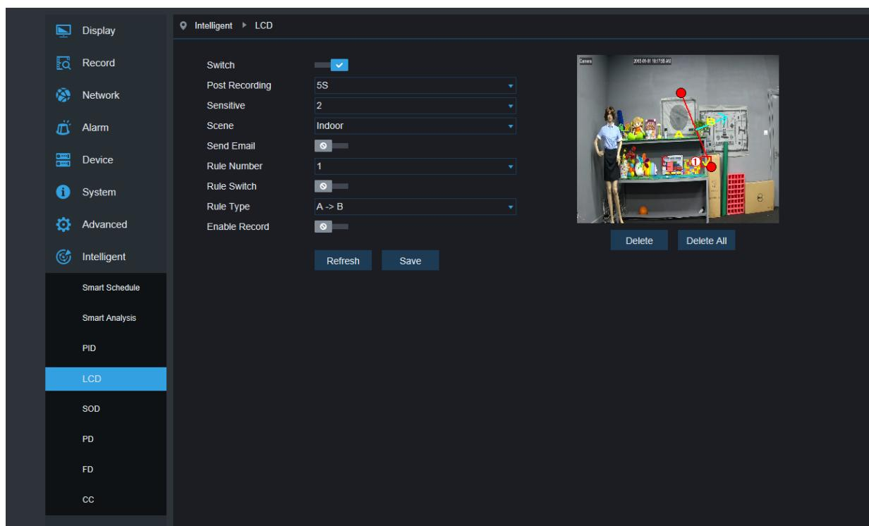
Описание функции: обнаружение и отслеживание на странице предварительного просмотра движущегося объекта, пересекшего линию
