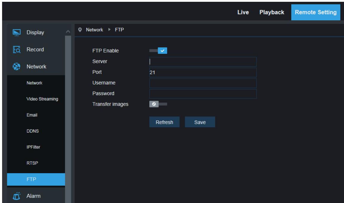
**FTP:** Настройка FTP сервиса - используется с функцией тревожного сигнала для загрузки изображений или видеозаписей, привязанных к FTP-серверу.
