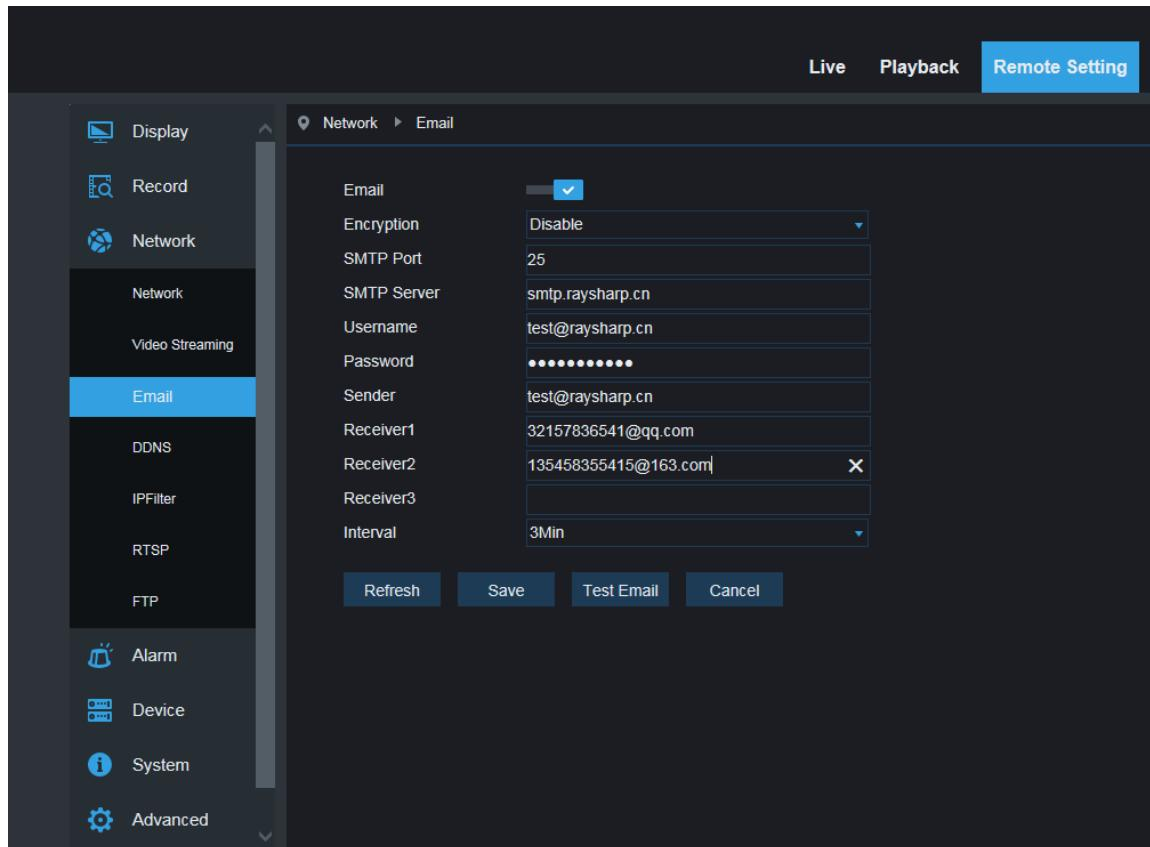
Настройка электронной почты: настройка почтового сервиса - используется с функцией тревожного сигнала для загрузки изображений, прикрепленных к почтовому серверу.
