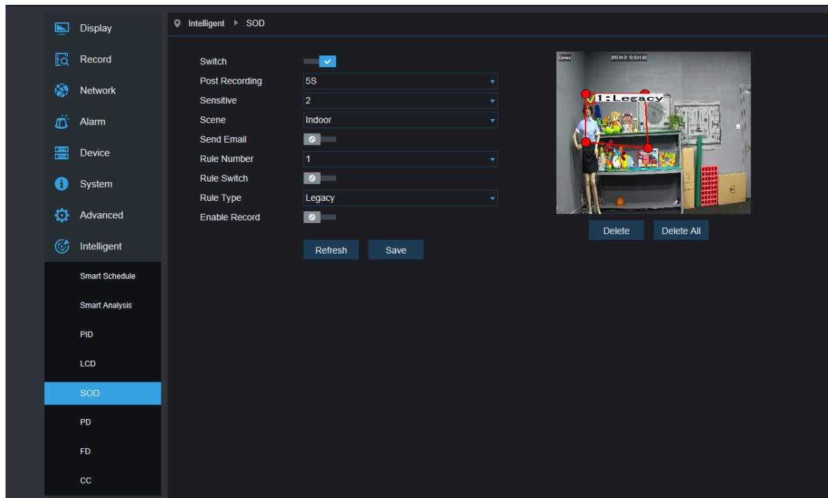
Описание функции: отображение на странице предварительного просмотра утерянного или оставленного без присмотра объекта, зафиксированного в одной наблюдаемых областей.
