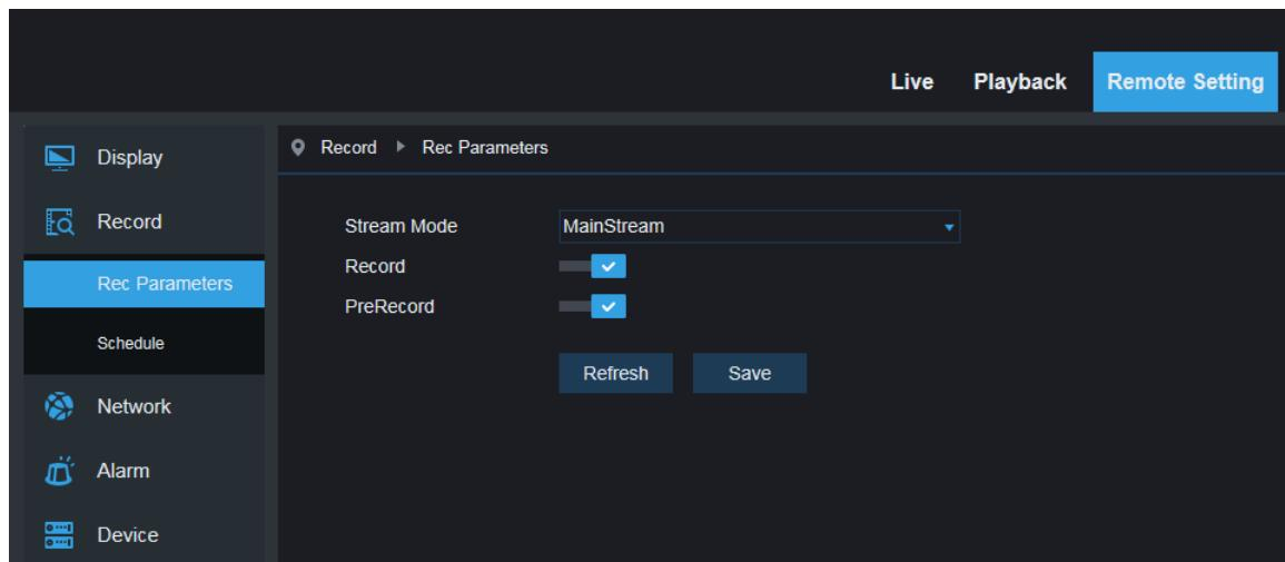
Эта функция предназначена для управления записью, предварительной записи и типом записи (основной поток и доп.поток).
