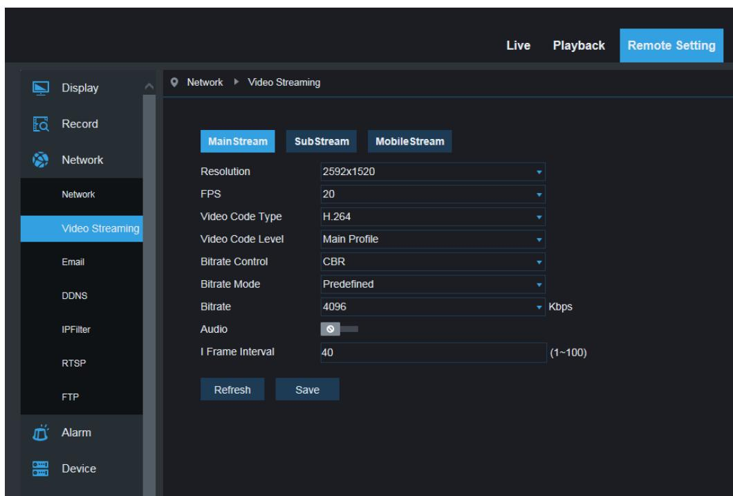
**По умолчанию доступными потоками являются:** основной поток, доп. поток и поток сотового телефона.
