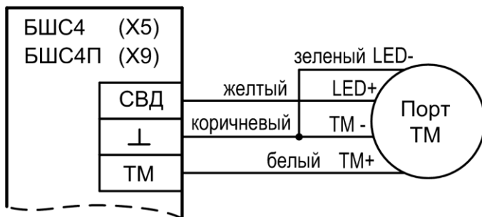
Рис.А12 Схема подключения порта Touch Memory к БШС4 и БШС4П
