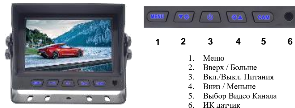
Рис. 2. Вид спереди. Органы управления монитора.
