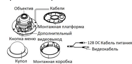
Рисунок 1-14 Купольная камера III типа
