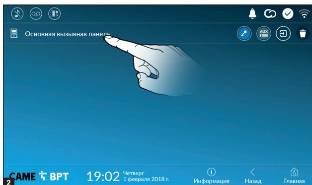
❶ Открывает дверь, присвоенную соответствующей вызывной панели, без установки соединения.
