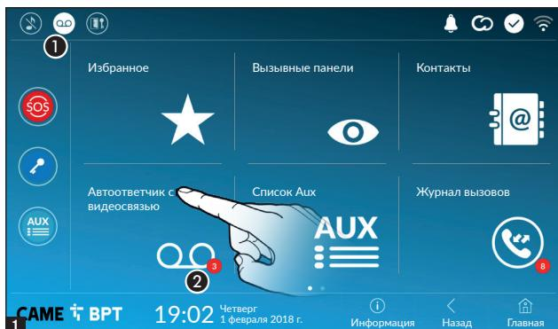
1 Коснитесь иконки для включения/выключения автоответчика.
