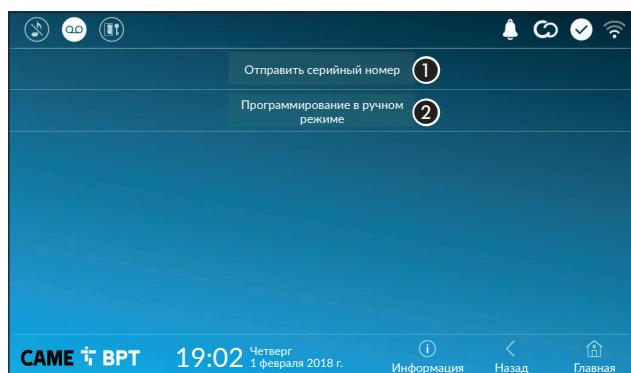
**1** Кнопка позволяет отправлять серийный номер (SN) программному обеспечению Pcs/Xip на этапе программирования.
