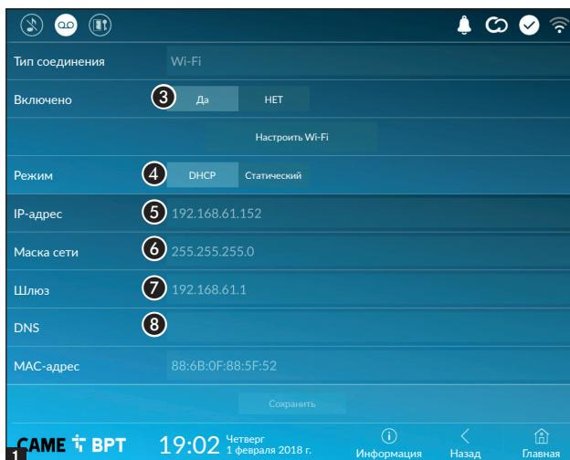
**3** Кнопка предназначена для включения/выключения соединения Wi-Fi.
