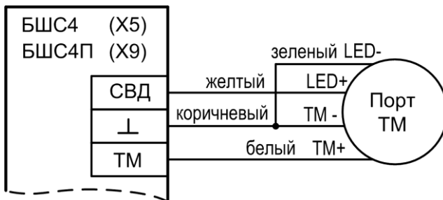
Рис.А12 Схема подключения порта Touch Memory к БШС4П
