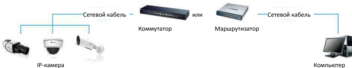
Рисунок 2-1-2 Подключение через коммутатор или маршрутизатор
