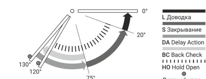
\* Указанные характеристики верны при установке доводчика строго по монтажной схеме с соблюдением ВСЕХ указанных размеров. В таблицах приведены примерные рабочие углы функций для дверного полотна толщиной ≤50 мм. Углы работы функций и максимальное время задержки закрывания двери могут отличаться в случае неправильной установки доводчика, увеличения толщины двери и выбранной мощности доводчика.
